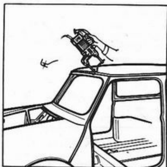
Soudage encadrement de baie ALA 5655 (partie supérieure) sur pavillon 14 A 5503 (électrode supérieure 100100) (électrode inférieure 100101) (Fig. CAR. 18)
