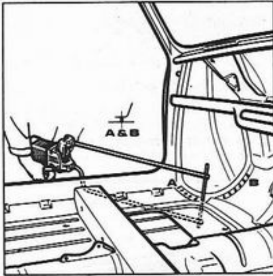
Soudage d'aile gauche 14 A 8389 sur : A : Plancher central 14 A 6491 B : Plancher de pédales 14 A 6487 (électrode supérieure 1088) | Ensemble 170572 (électrode inférieure 1082) (Fig. CAR. 15)
